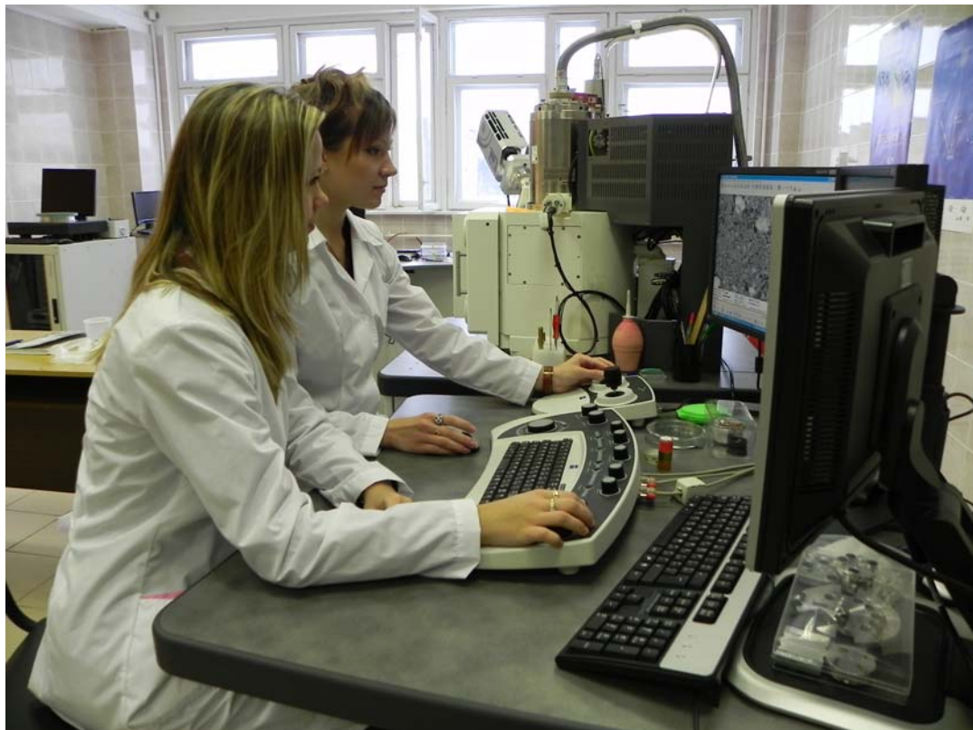
Лабораторный практикум по сканирующей электронной микроскопии. ЦКП «Диагностика микро- и наноструктур», сканирующий автоэмиссионный электронный микроскоп Supra 40
